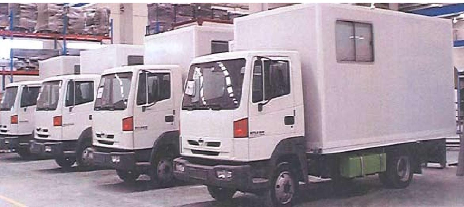
Vehículos de gran capacidad de carga y con diferentes opciones: marca y tipo de chasis, motor, tracción sencilla o doble, suspensión común o reforzada, etc. Además, los vehículos se equipan con multitud de accesorios: aire acondicionado, antena de telecomunicaciones, equipo de telemedicina, tanques de agua potable, generadores...
